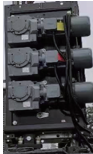
图1.4-3 BZ（4S2063）型驱动系统
