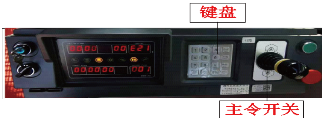
图3.2-3 操作台示意图
