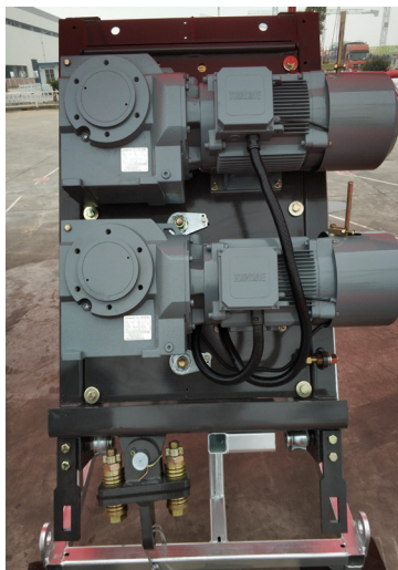
图1.4-2 EB-A（4S2050）型驱动系统
