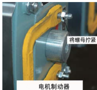
图1.3-9 国产电机制动器
