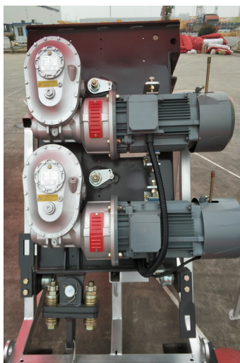
图1.4-1 EB（4S2040）型驱动系统
