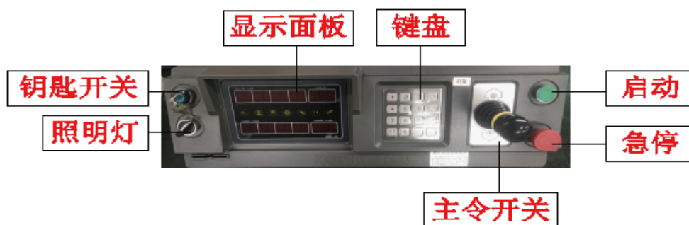
图1.3-1 4S（精英版）操作台
